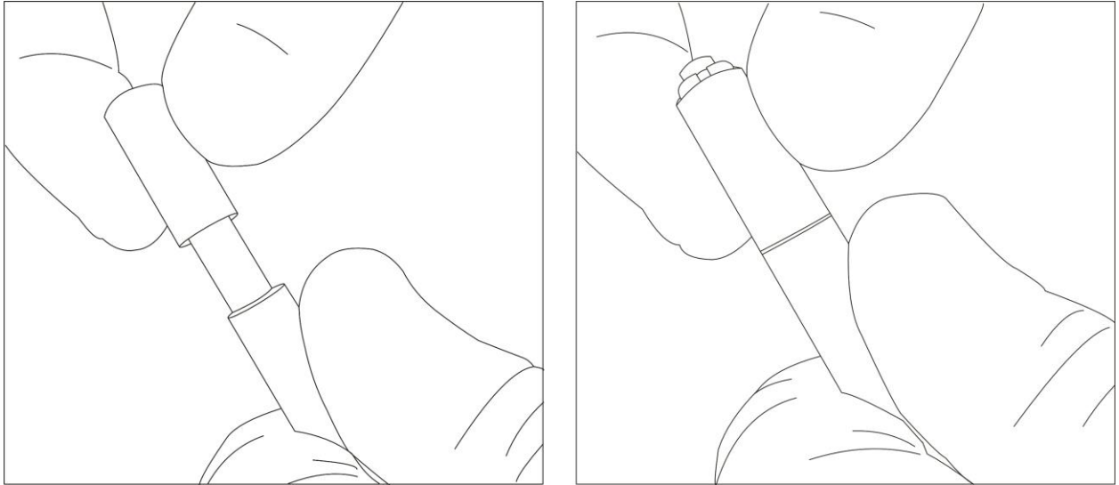
Figura 28. Installazione dell'essiccante sull'essiccatore del manicotto
