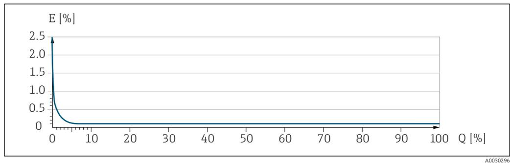
E Error máximo de medición en % v.l. (ejemplo)
