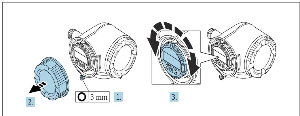
1. Según la versión del equipo: Afloje la abrazadera de sujeción de la cubierta del compartimento de conexiones.
