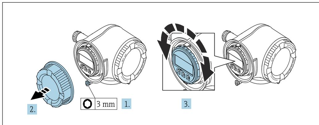
1. In base alla versione del dispositivo: liberare il fermo di sicurezza sul coperchio del vano connessioni.
