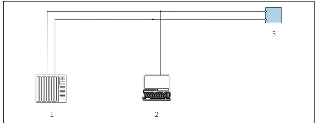
31 Opzioni per funzionamento a distanza mediante protocollo Modbus RS485 (attivo)
