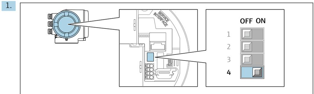
Impostare l'interruttore protezione scrittura (SIM) sul modulo dell'elettronica principale in posizione **ON** (valore di fabbrica):
