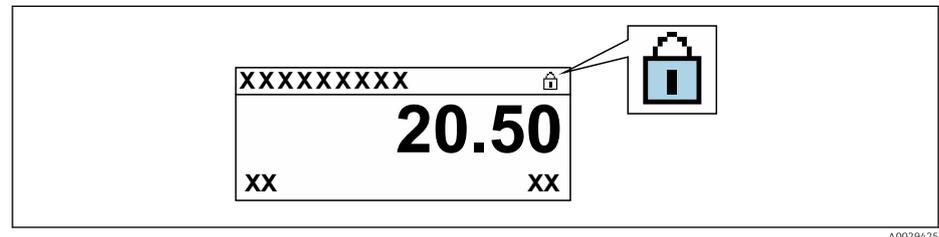
2. Impostando il microinterruttore di protezione scrittura (WP) sul modulo dell'elettronica principale in posizione **OFF** (impostazione di fabbrica), si disattiva la protezione scrittura hardware.
