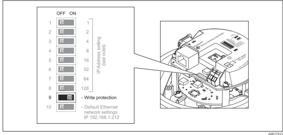
La posición **ON** del interruptor de protección contra escritura situado en el módulo del sistema electrónico de E/S habilita la protección contra escritura por hardware. La posición **OFF** (ajuste de fábrica) del interruptor de protección contra escritura situado en el módulo del sistema electrónico de E/S deshabilita la protección contra escritura por hardware.
