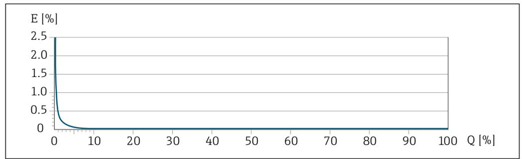
*E* Écart de mesure maximal en % de *m*. (exemple avec PremiumCal)
