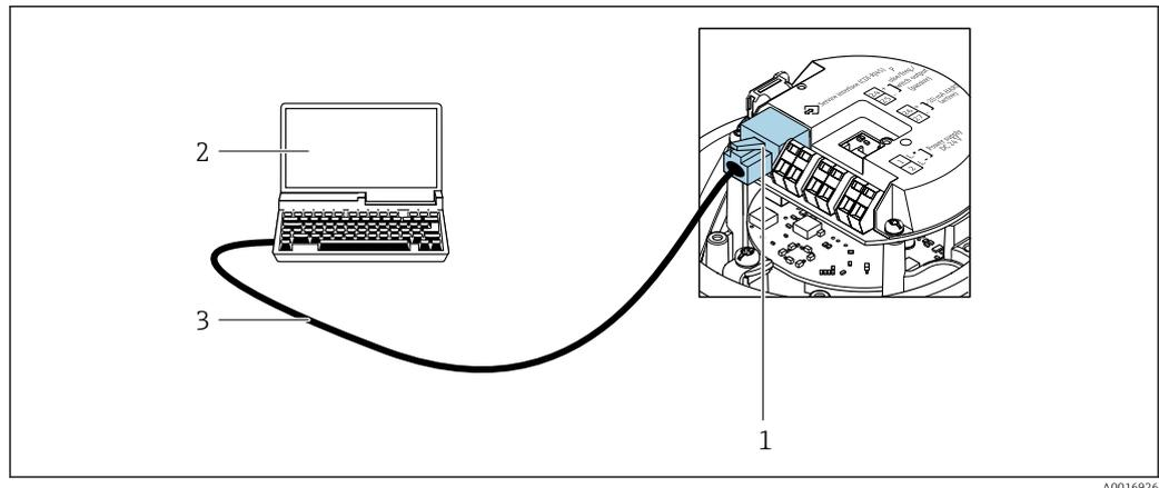
21 Raccordement pour caractéristique de commande "Sortie", Option B : 4-20 mA HART, sortie impulsion/fréquence/tor
