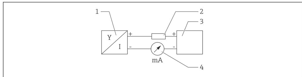
図 2 HART 接続のブロック図
