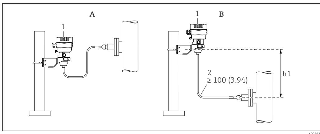
A Рекомендуемый вариант монтажа при эксплуатации в условиях вакуума
