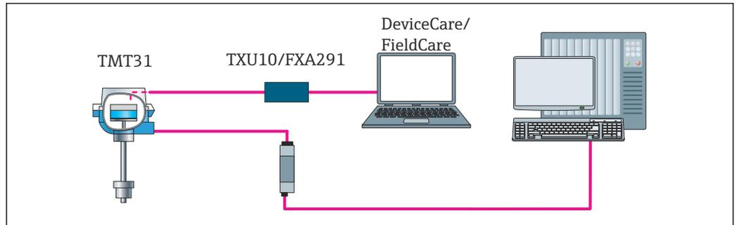
10 Bedienungsmöglichkeiten des Transmitters über die CDI-Schnittstelle
