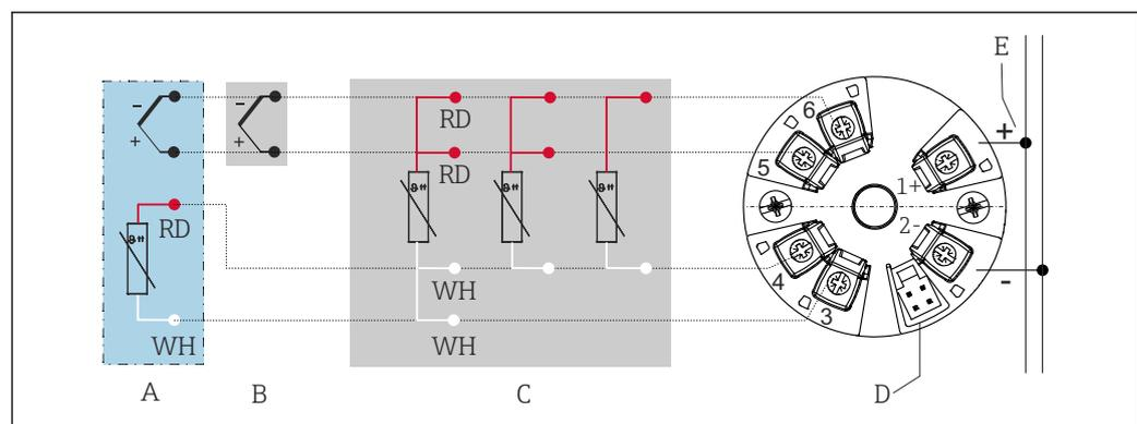
**5** Klemmenbelegung Kopftransmitter
