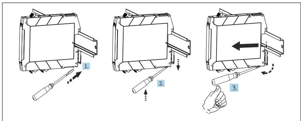
4 Hutschienentransmitter demontieren
