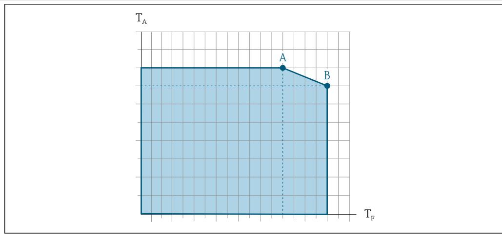
$T_A$  环境温度 $T_F$  介质温度A  $T_{A\ max} = 60\ ^\circ\text{C}$  (140 °F) 时的最高允许介质温度; 更高介质温度需要降低环境温度  $T_F$  (减温)
