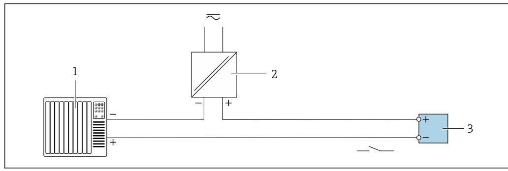
图 12 继电器输出的连接实例(无源)
