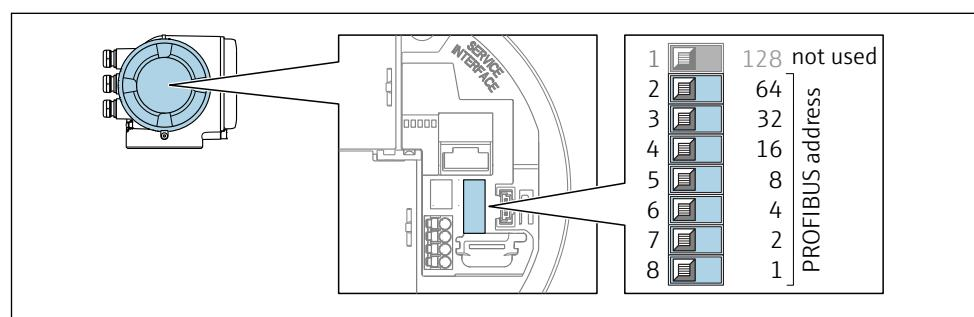
通过接线腔中的 DIP 开关设置设备地址。
