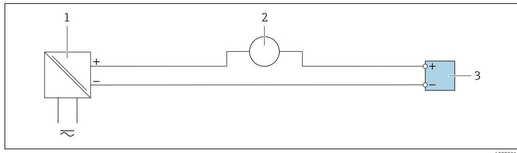
图 13 4...20 mA 电流输入的连接实例
