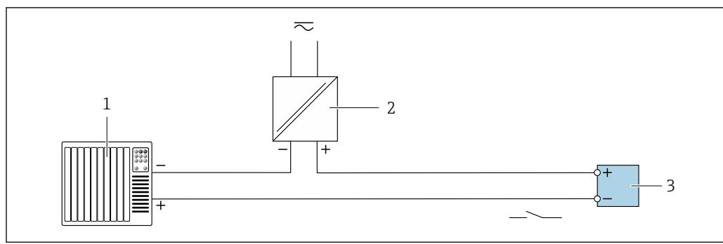
图 11 开关量输出(无源信号)的连接实例
