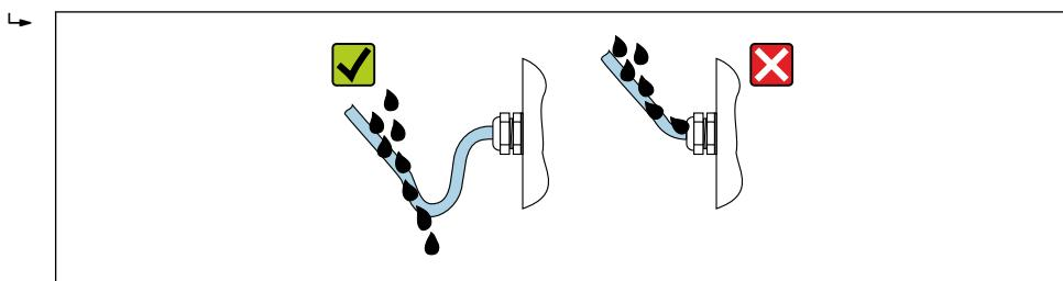
6. 将堵头安装在未使用的电缆入口中。
