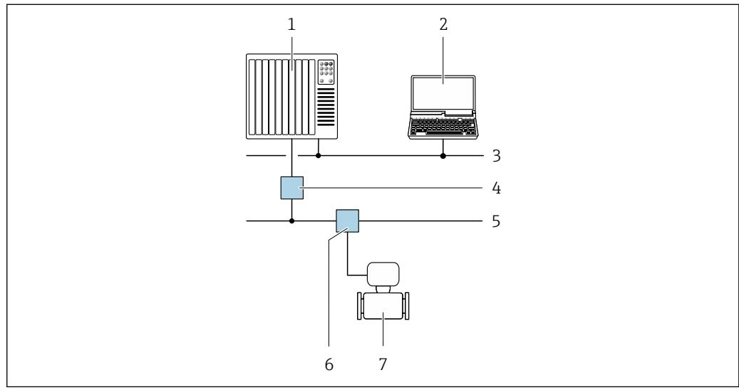
图 17 通过 PROFIBUS PA 网络进行远程操作
