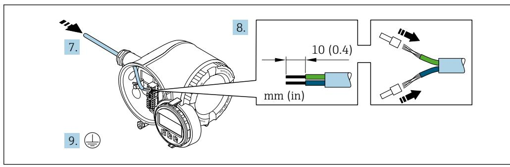
7. 将电缆插入电缆入口中。请勿拆除电缆入口上的密封圈，确保牢固密封。
