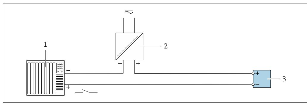
图 14 状态输入的连接实例
