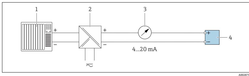
图 9 4...20 mA 无源电流输出的连接实例
