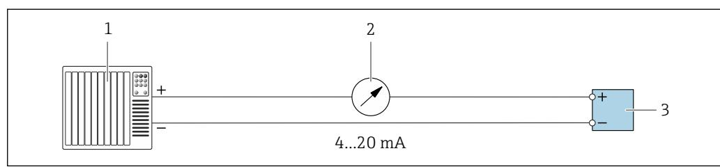
图 8 4...20 mA 有源电流输出的连接实例
