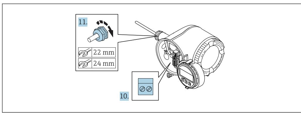
10. 参考接线端子分配连接电缆。
