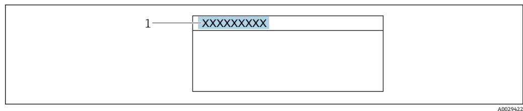
图 21 带位号名的操作显示的标题栏
