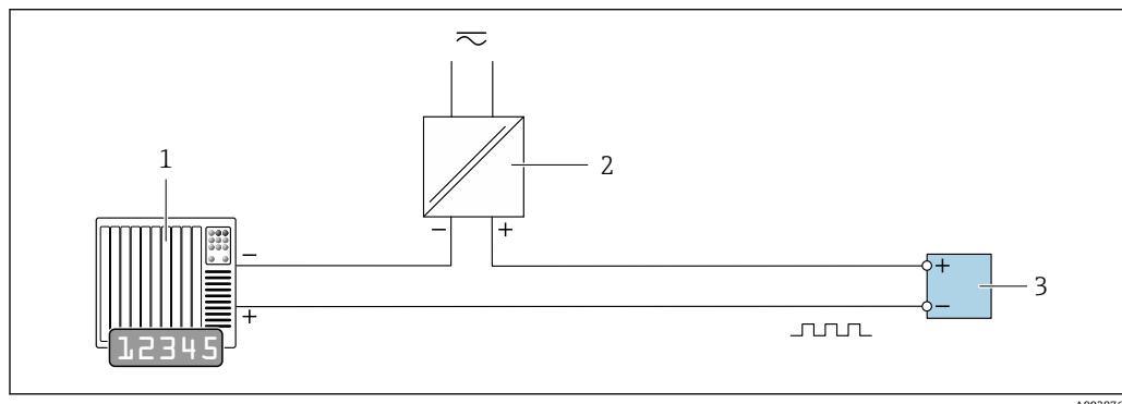
图 10 脉冲/频率输出(无源信号)的连接实例
