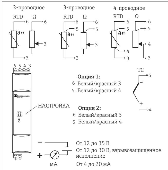
3: Разводка клемм
