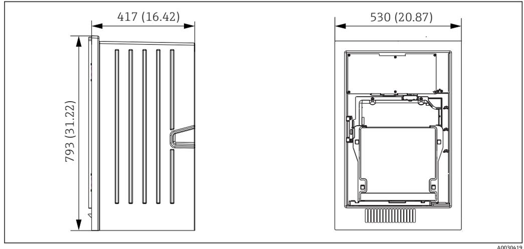
图 14 Liquiline System CA80 的外形尺寸示意图 (柜门打开) ; 单位: mm (in)
