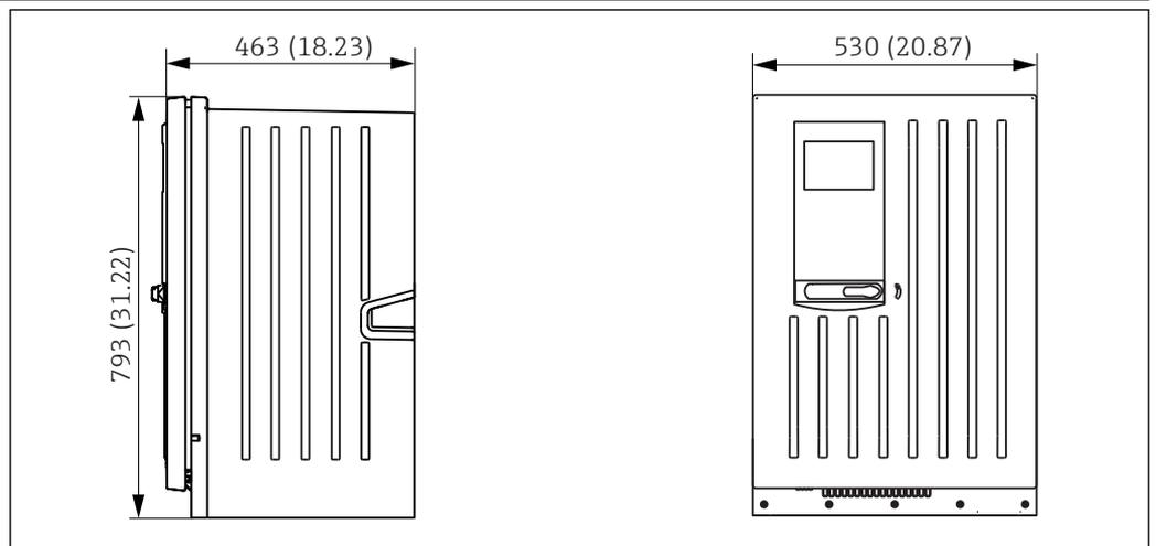
图 13 Liquiline System CA80 的外形尺寸示意图 (柜门关闭); 单位: mm (in)
