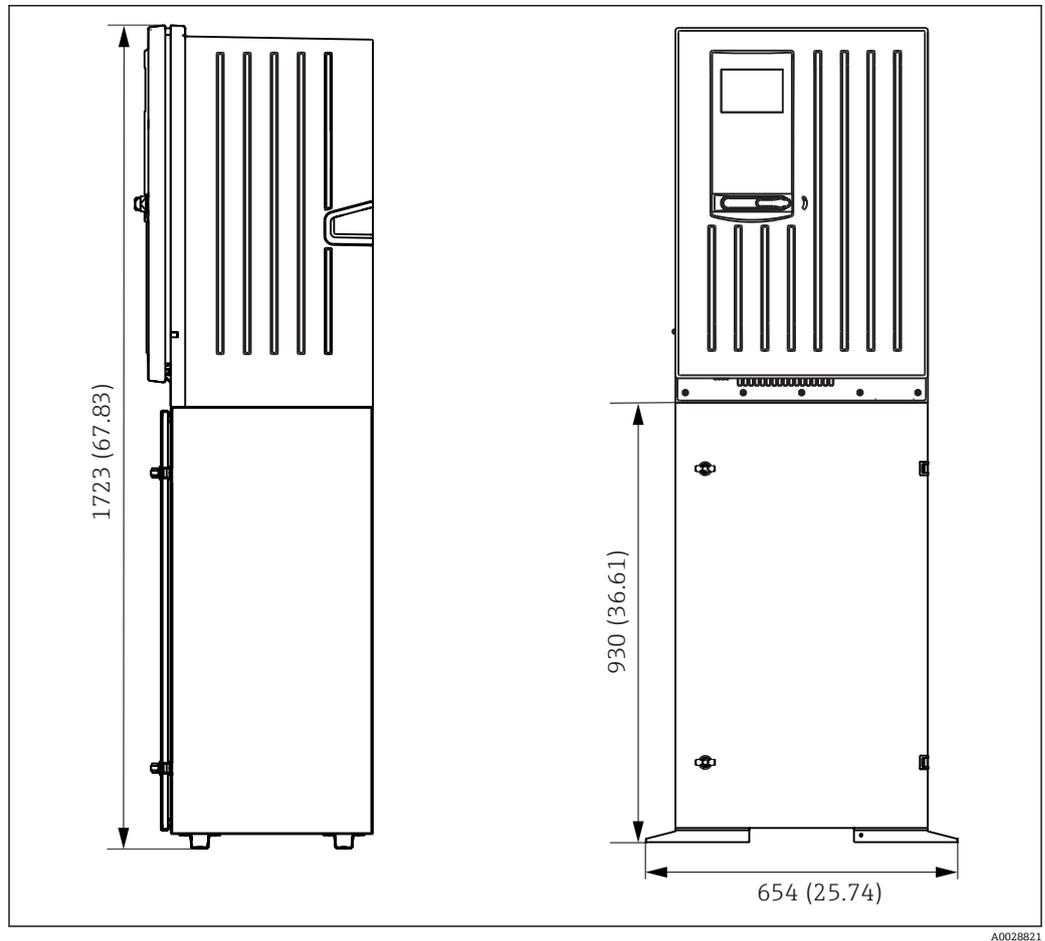
图 15 Liquiline System CA80 的外形尺寸示意图 (带安装底座) ; 单位: mm (in)
