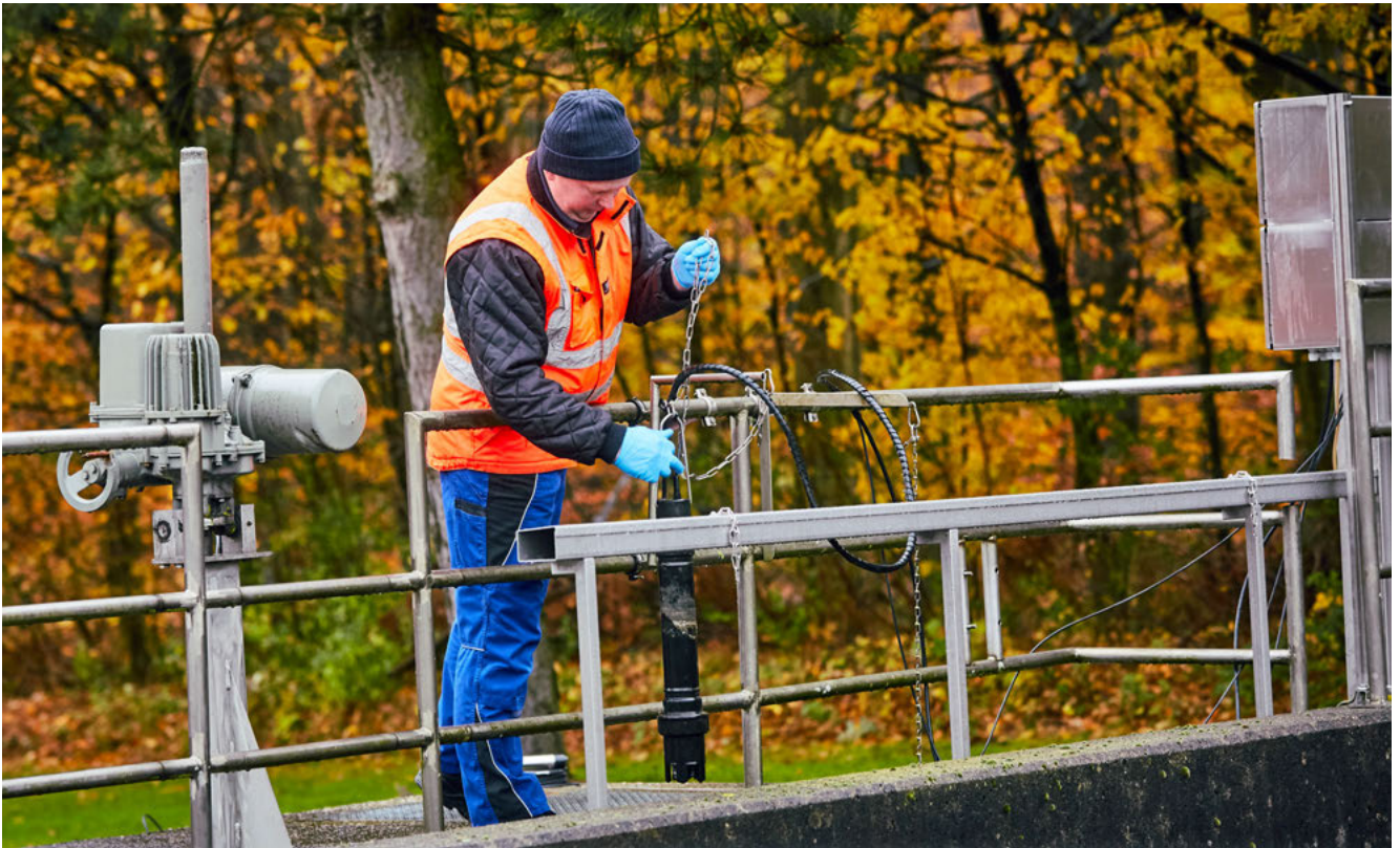
Mit dem ionenselektiven Sensor ISEmax CAS40D messen Sie Ammonium und Nitrat direkt im Belebungsbecken. Damit lässt sich der Stickstoffabbau in der Biologie frachtabhängig regeln – und der Prozess optimieren.
