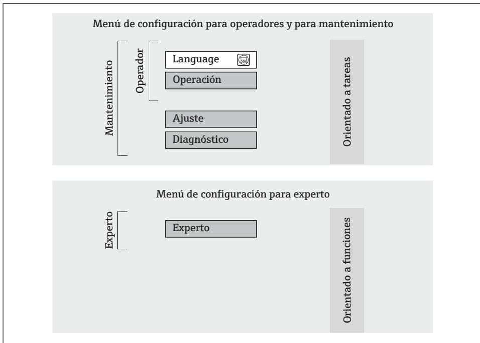
9 Estructura esquemática del menú de configuración
