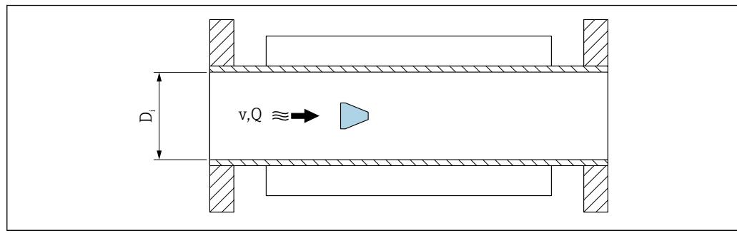
$D_i$  测量管内径 (对应外形尺寸 K)
