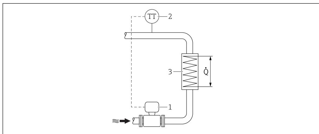
图 7 饱和蒸汽和水的热量差值测量的系统示意图
