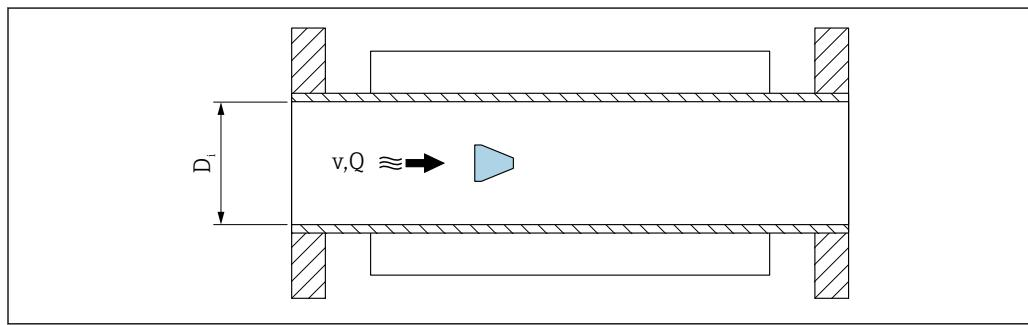
D<sub>i</sub> 测量管内径 (对应外形尺寸 K)
