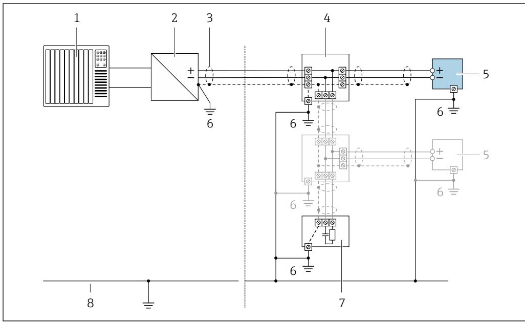
图 10 PROFIBUS PA 的接线实例
