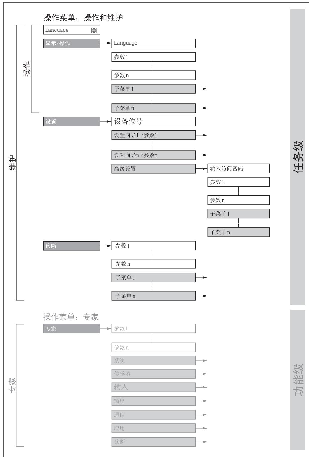
图 15 操作菜单的结构示意图
