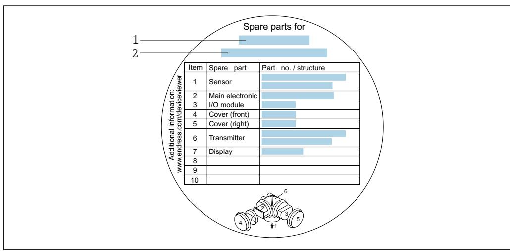
图 25 接线腔盖中的“备件概述标签”示例
