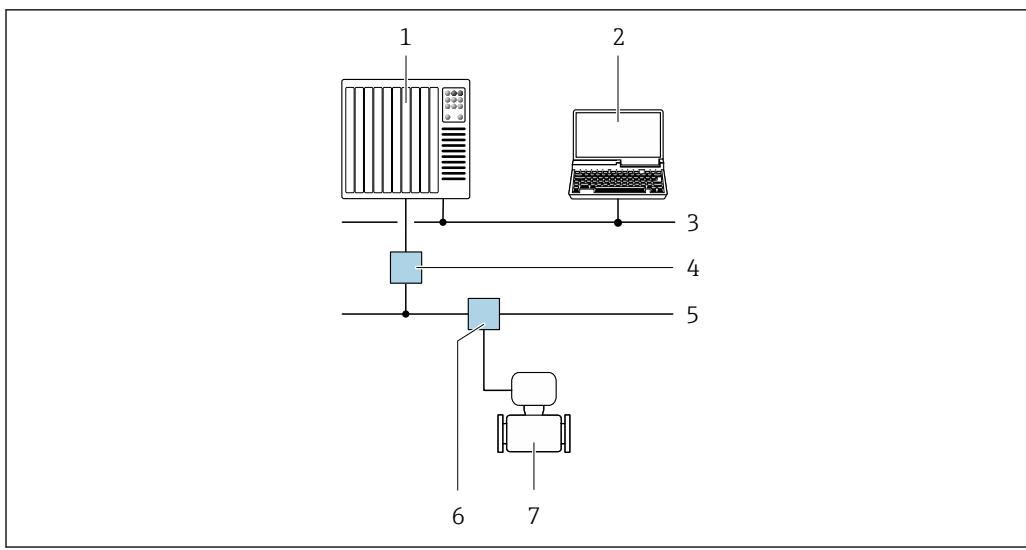
图 17 通过 PROFIBUS PA 网络进行远程操作
