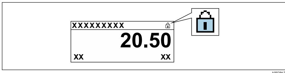
硬件写保护关闭时，**锁定状态** 参数中无选项显示。在现场显示中，操作显示和菜单视图中的参数前的图标消失。
