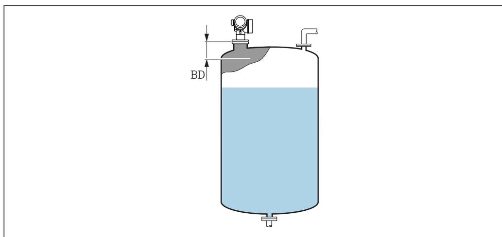
**49** Distance de blocage (BD) pour la mesure dans les liquides
