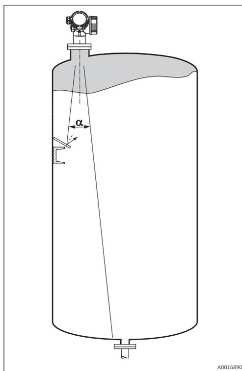
Des plaques métalliques inclinées diffusent les signaux radar et permettent ainsi d'éviter les échos parasites.
