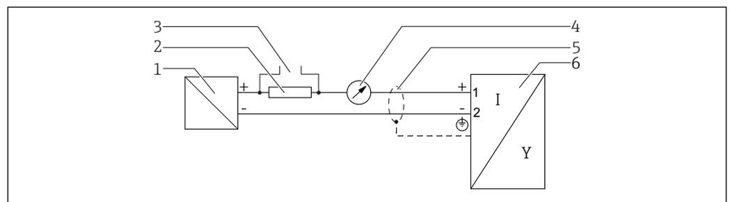
11 Schéma de principe 2 fils : 4-20 mA HART
