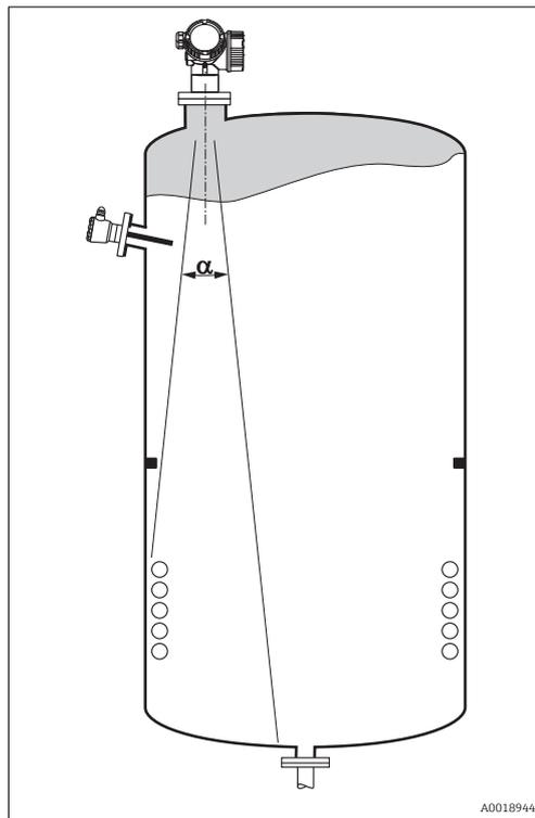
Eviter que des éléments internes (fins de course, sondes de température, renforts, anneaux à vide, serpentins de chauffage, déflecteurs, etc.) ne se trouvent dans le faisceau d'ondes. Tenir compte de l'angle d'émission → ☰ 23.
