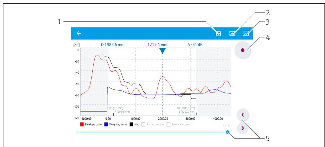
33 Krzywa obwiedni echa (przykładowa) w aplikacji SmartBlue; widok na urządzeniu z systemem Android
