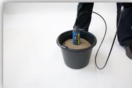
4. Messung mit dem HD2 Handmessgerät durchführen
