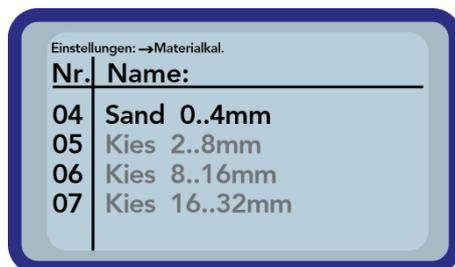
Durch betätigen der Tasten „Hoch“ ▲ und „Runter“ ▼ wird durch die Liste geblättert und die gewünschten Kalibrierungen ausgewählt. Dabei zeigt das „!“ vor einer Kalibrierung die aktuell aktive an. Durch Druck auf die Taste „Messen“ C setzen Sie die ausgewählte Kalibrierung als aktive Kalibrierung. Nach einem kurzen Moment erscheint das Symbol □ in der oberen rechten Displayecke und zeigt an, dass die Auswahl aktiviert wurde. Außerdem erscheint das „!“ vor der aktiven Kalibrierung.
