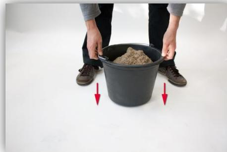
3. Sonde in den Sand einstecken, erreicht der Sondenboden die Sandoberfläche, dann noch etwas nachdrücken (weder an der Sonde wackeln noch diese während des Einbringens drehen!)
