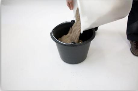
2. Sand durch 5-faches, senkrecht anheben und auf den Boden fallen lassen des Behälters aus ca. 5cm Höhe verdichten (ist nach 5-maligem fallenlassen noch eine weitere Verdichtung des Materials erkennbar diese Prozedur weitere Male durchführen)
