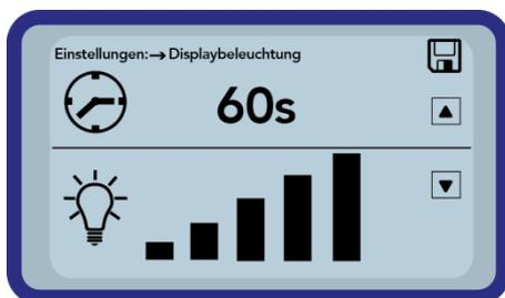
Mit der Taste „Hoch“
