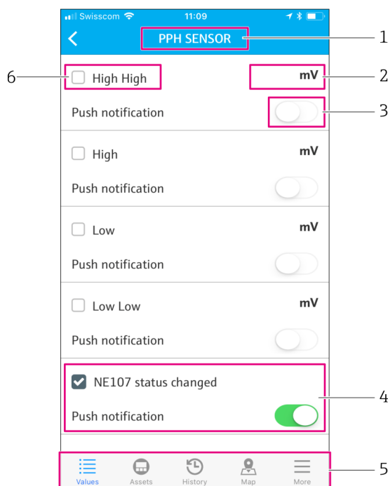
📄 23 Vista de ajustes de alarma
