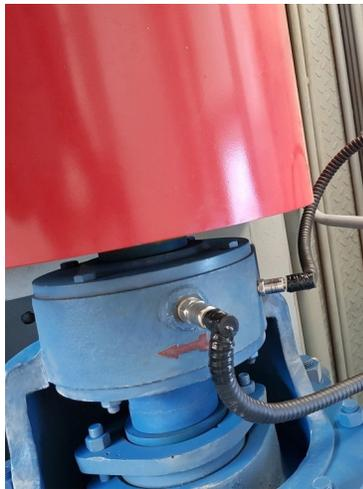
Компактные термометры Easytemp TMR31 обеспечивают надежный контроль температуры подшипников.
