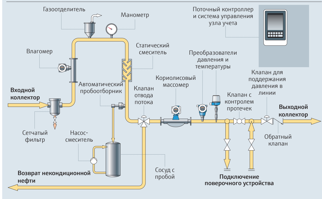
Обобщенный состав оборудования Автоматизированного узла учета нефти и нефтепродуктов
