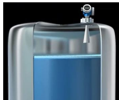
La mousse est détectée par la réduction de l'amplitude de l'écho.
