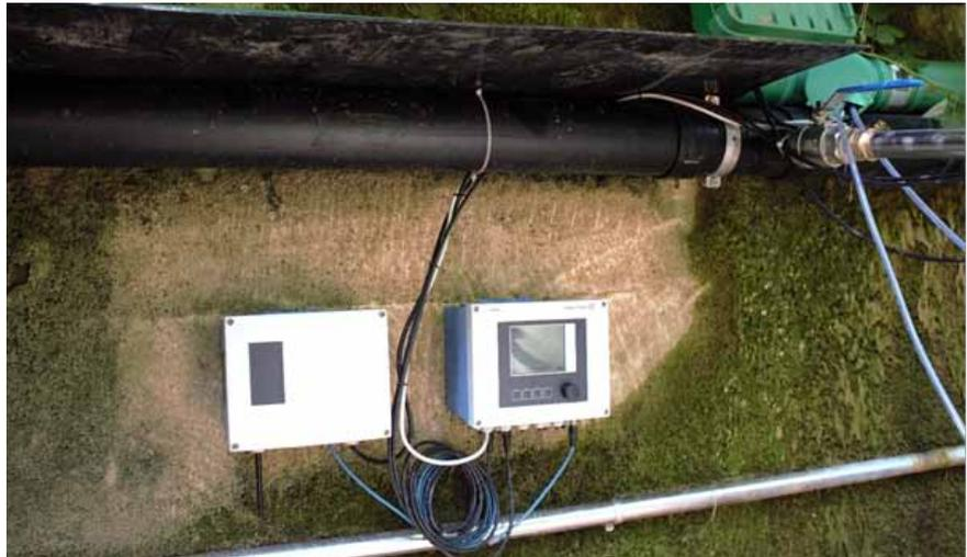
Modbus Edge Device und Messumformer Liquiline
