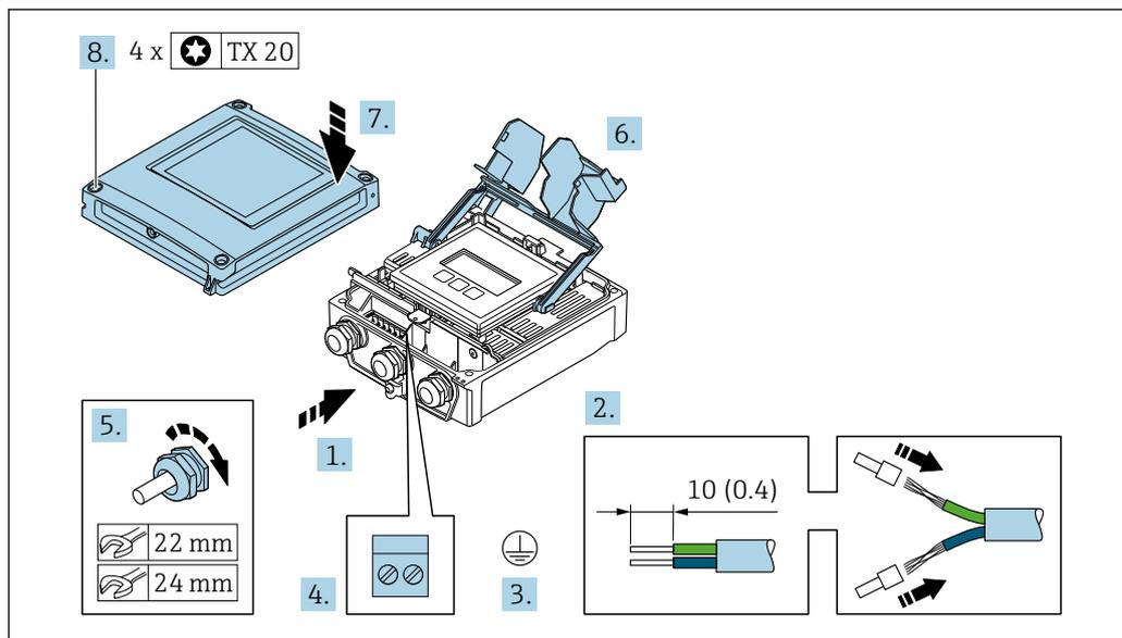
1. Passer le câble à travers l'entrée de câble. Ne pas retirer la bague d'étanchéité de l'entrée de câble, afin de garantir l'étanchéité.
