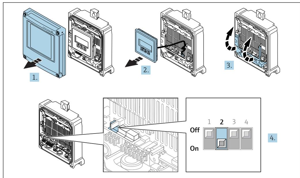
1. Desserrer les 4 vis de fixation du couvercle du boîtier.
