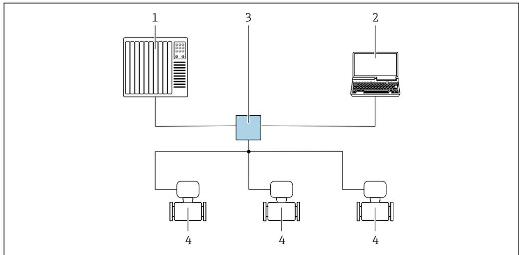
📄 33 Options de configuration à distance via réseau PROFINET : topologie en étoile
