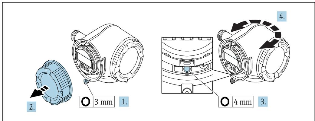
1. Selon la version d'appareil : Desserrer le crampon de sécurité du couvercle du compartiment de raccordement.
