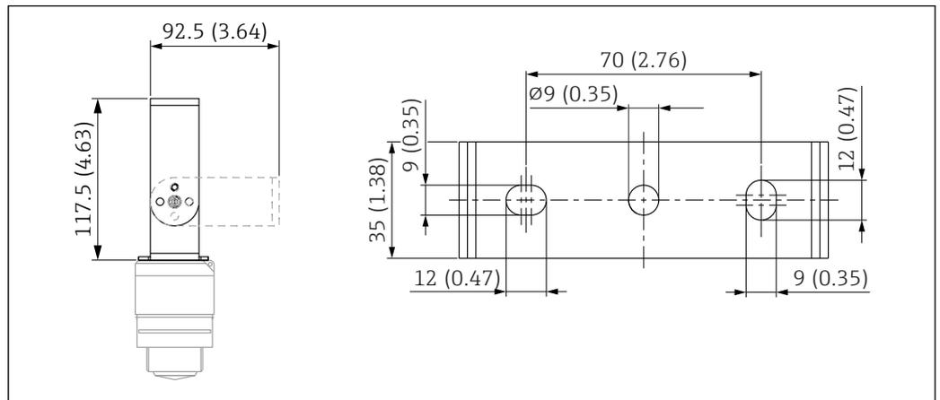
38 Dimensioni della staffa di montaggio, unità ingegneristica: mm (in)
