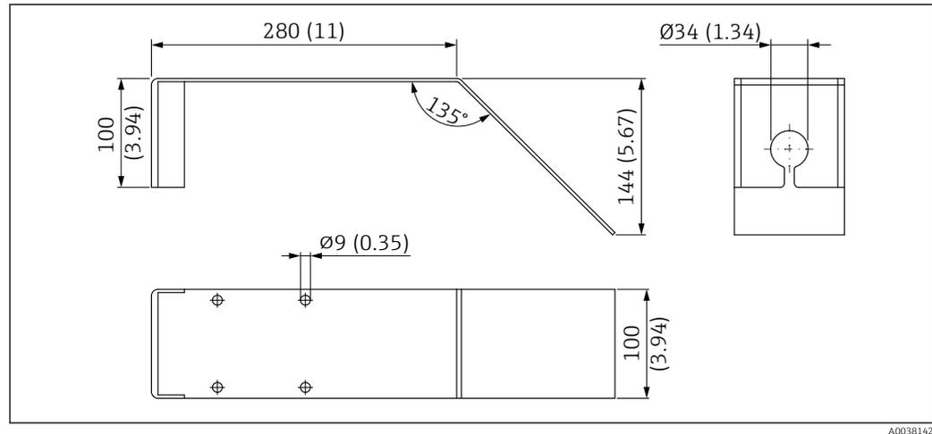
56 Dimensioni staffa di montaggio orizzontale per pozzetti per fognatura. Unità di misura mm (in)
