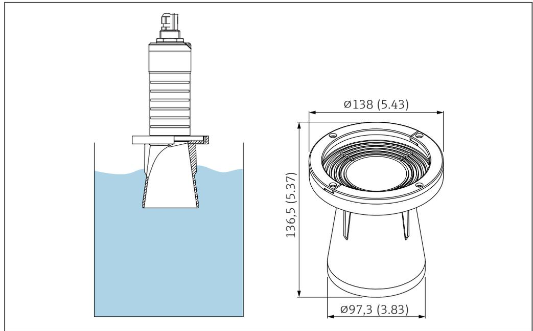
37 Dimensioni del tubo di protezione da allagamento 80 mm (3 in); unità ingegneristica: mm (in)
