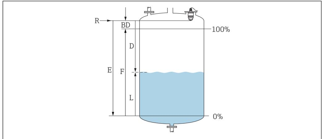
Fig. 28 Parametri di configurazione per la misura di livello nei liquidi
