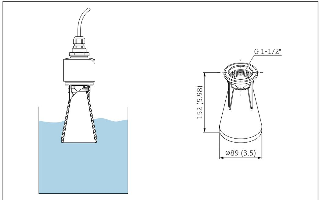
36 Dimensioni del tubo di protezione da allagamento 40 mm (1,5 in); unità ingegneristica: mm (in)
