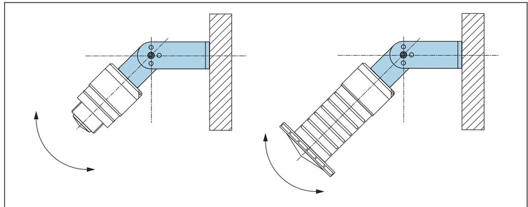
Fig. 11 Installazione con staffa di montaggio, regolabile
