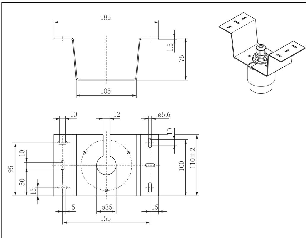
54 Dimensioni della staffa di montaggio a soffitto. Unità di misura mm (in)
