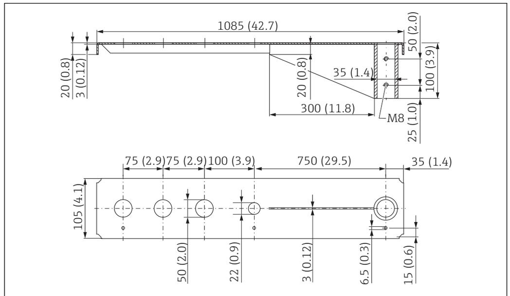
48 Dimensioni della trave a mensola (lunga) con cardine per connessione al processo del sensore G 1-1/2" sul lato anteriore. Unità di misura mm (in)
