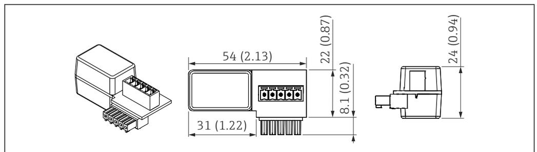
58 Dimensioni del resistore di comunicazione HART, unità ingegneristica: mm (in)
