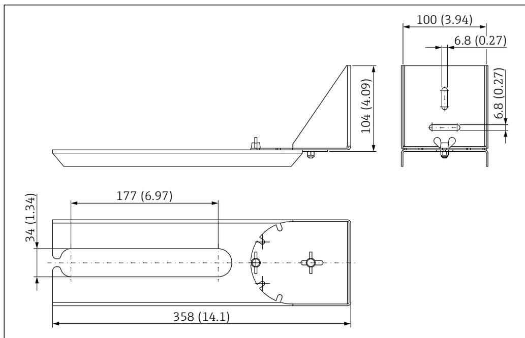
55 Dimensioni della staffa di montaggio con cardine. Unità di misura mm (in)
