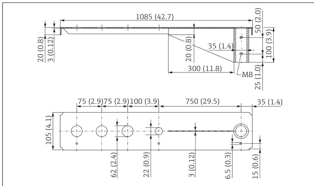
50 Dimensioni della trave a mensola (lunga) con cardine per la connessione al processo del sensore G 2" su fronte. Unità di misura mm (in)
