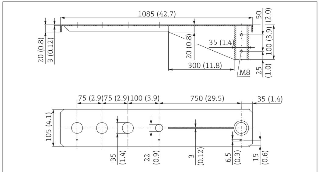
45 Dimensioni della trave a mensola (lunga) con cardine per la connessione al processo del sensore sul lato posteriore. Unità di misura mm (in)
