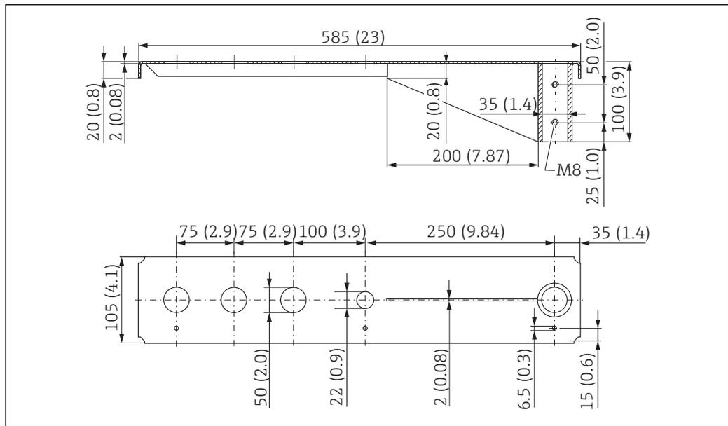
47 Dimensioni della trave a mensola (corta) con cardine per connessione al processo del sensore G 1-1/2" sul lato anteriore. Unità di misura mm (in)
