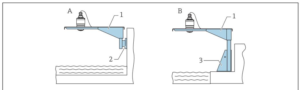
46 Tipo di installazione con connessione al processo del sensore sul lato anteriore
