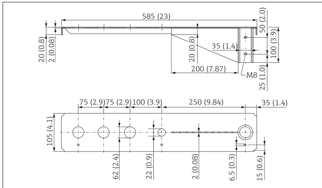
49 Dimensioni della trave a mensola (corta) con cardine per la connessione al processo del sensore G 2" su fronte. Unità di misura mm (in)
