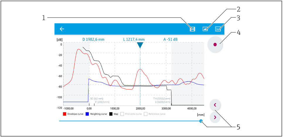
図 20 SmartBlue (Android 版) での反射波形表示 (例)
