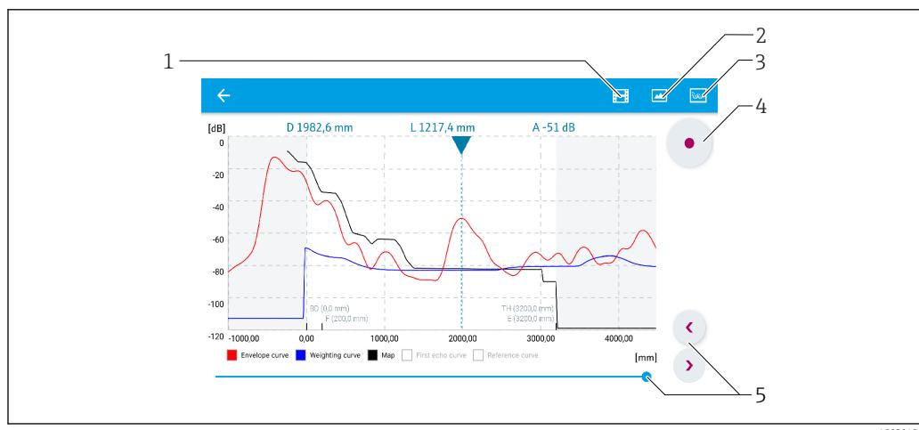
図 25 SmartBlue (Android版) での反射波形表示 (例)
