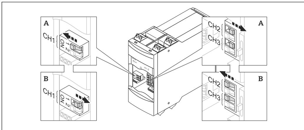
A Módulo de la electrónica FEL56: señal de corriente de fallos > 2,1 mA
