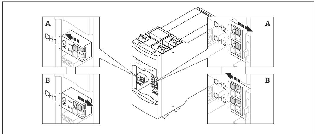
A Unidade eletrônica FEL56: sinal de corrente de falha > 2,1 mA
