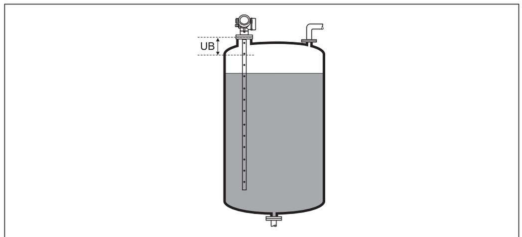
**59** Blockdistanz (UB) bei Messung in Flüssigkeiten
