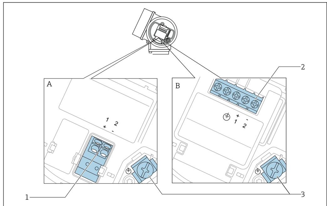
13 Klemmenbelegung 2-Draht: 4-20 mA HART
