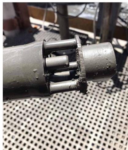
CPA111 avec des capteurs recouverts de boue, avant le nettoyage.
