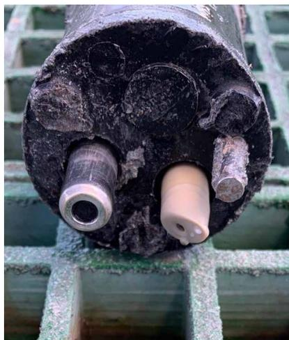
CPA111 avec COS81D et CPS47D au point de mesure du lessivage du cyanure. Les supports de protection en plastique sont complètement usés, mais les capteurs ne le sont pas.
