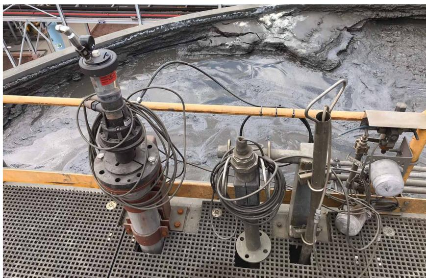
Un point de mesure au niveau de la cuve de lessivage.
