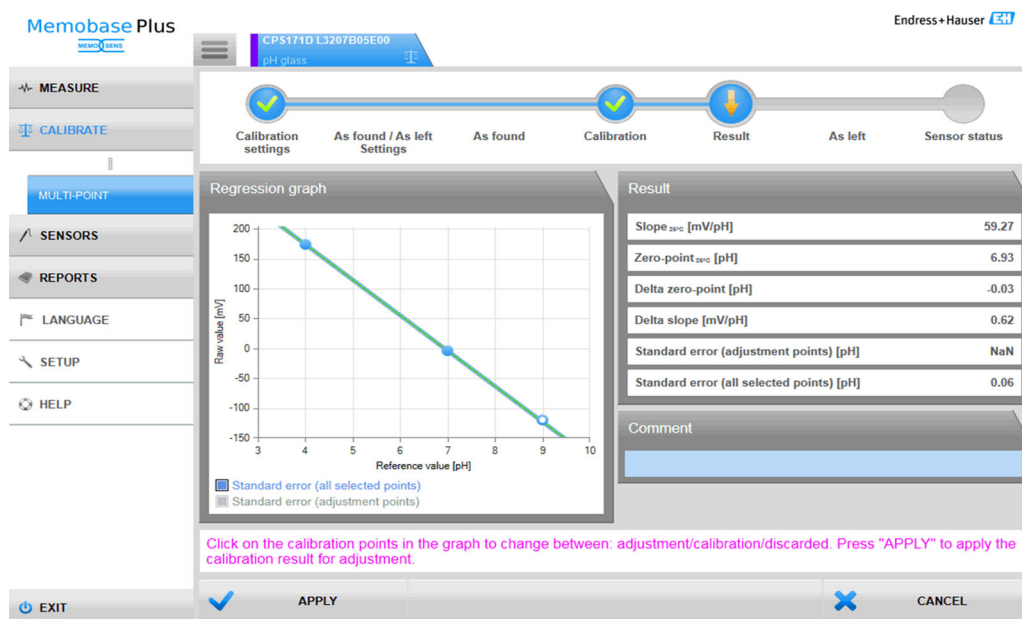
4 Calibración multipunto (licencia "Advanced diagnostics"): selección de las soluciones amortiguadoras 4 y 7 como puntos de ajuste y de la solución amortiguadora 9 como punto de calibración
