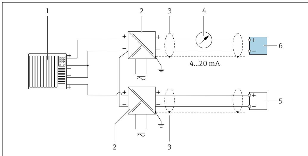
図 11 マイナスコモンの HART 入力（パッシブ）の接続例
