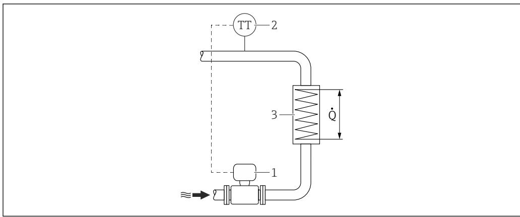
図 16 飽和蒸気/水の差エネルギー計測
