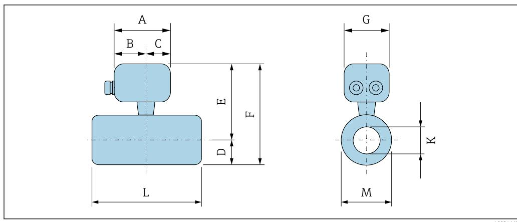
**EN (DIN) : PN 250 準拠の突合せ溶接バージョン
