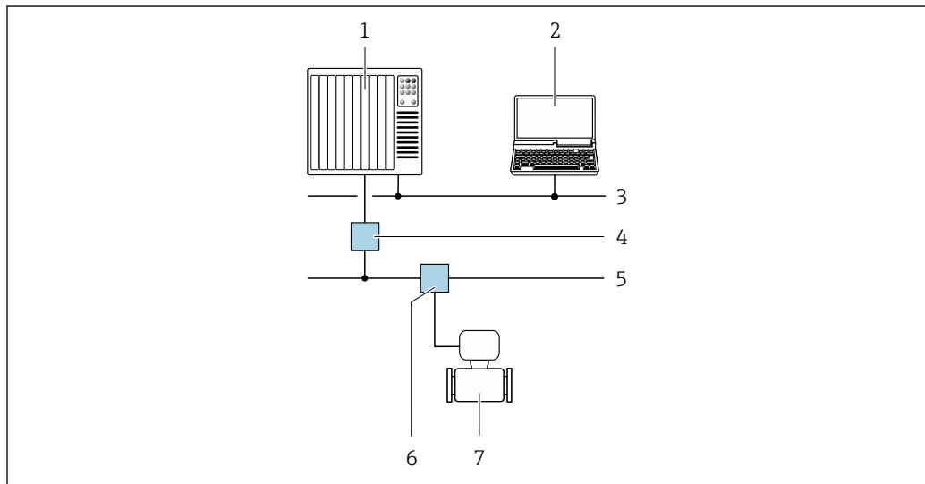
図 26 PROFIBUS PA ネットワークを介したリモート操作用のオプション
