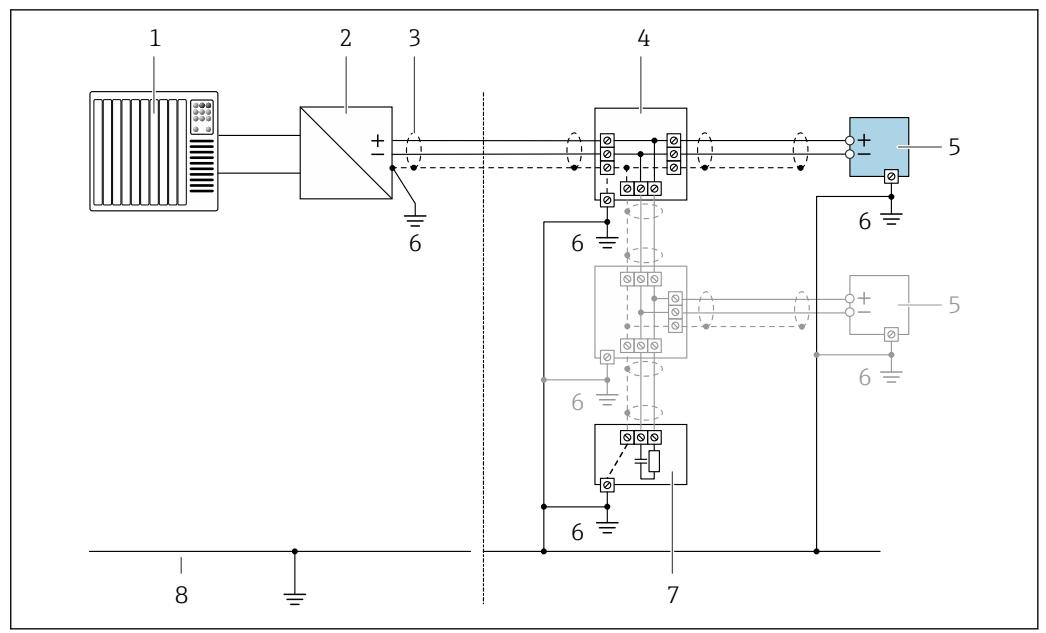
図 8 FOUNDATION フィールドバスの接続例
