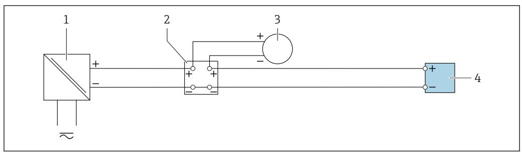
図 10 4~20 mA 電流入力の接続例
