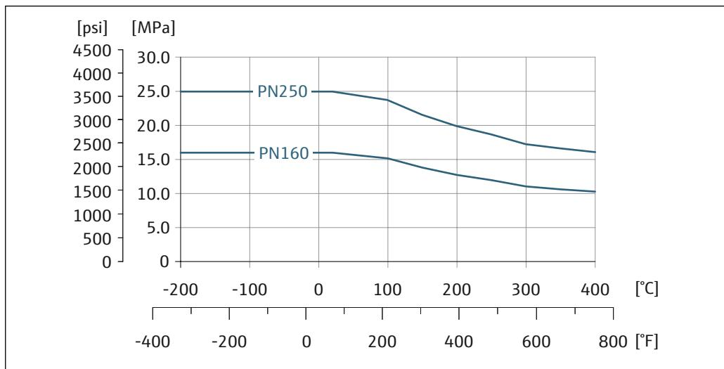
図 17 フランジ接続材質：ステンレス鉄鋼、複数の認証、1.4404/SUS F316 または F316L 相当
