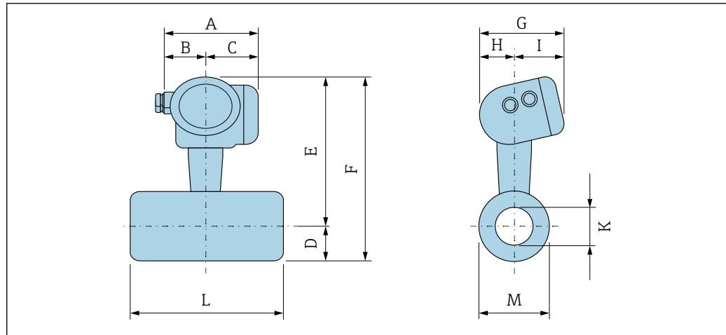
EN (DIN) : PN 250 準拠の突合せ溶接バージョン
