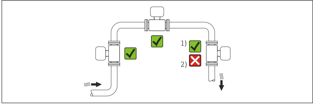
1 気体および蒸気に適した設置
