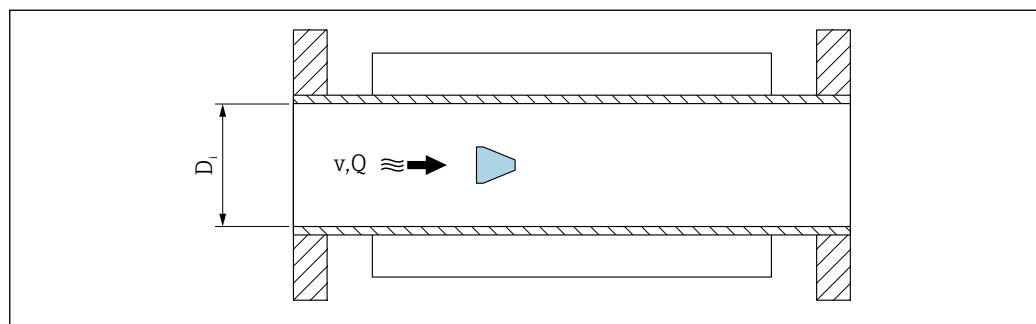
$D_i$  計測チューブの内径 (寸法 K に相当 → 図 53)
