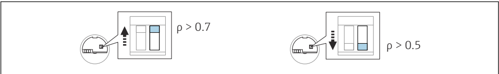
図 43 エレクトロニックインサートの密度のスイッチ位置
