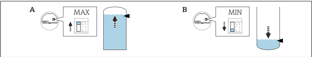
図 42 エレクトロニックインサートのフェールセーフモード MAX/MIN のスイッチ位置
