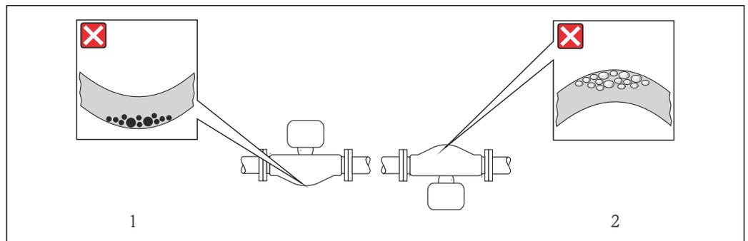
☒ 19 Einbaulage Messaufnehmer mit gebogenem Messrohr
