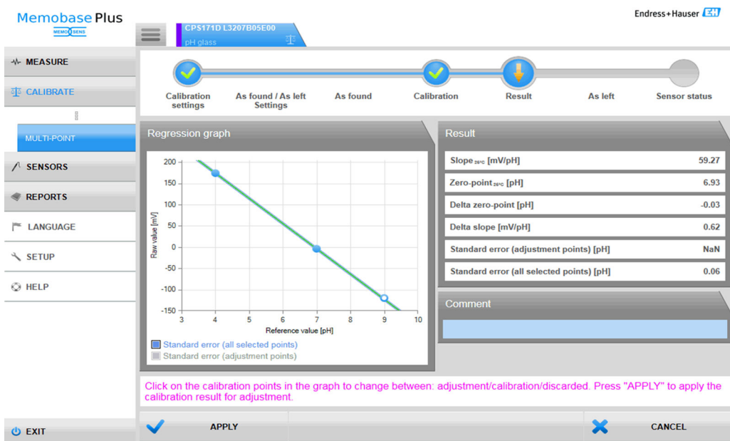
図 16 多点校正：調整点として標準液 4 と 7 を選択し、校正点として標準液 9 を選択
