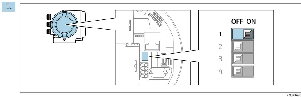
Для активации аппаратной защиты от записи (WP) установите переключатель защиты от записи в главном электронном модуле в положение **ВКЛ**.
