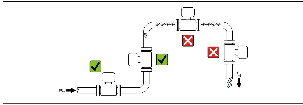
Скапливание пузырьков газа в измерительной трубе может привести к увеличению погрешности измерения. Поэтому не допускается монтаж измерительной системы в следующих точках трубопровода:
