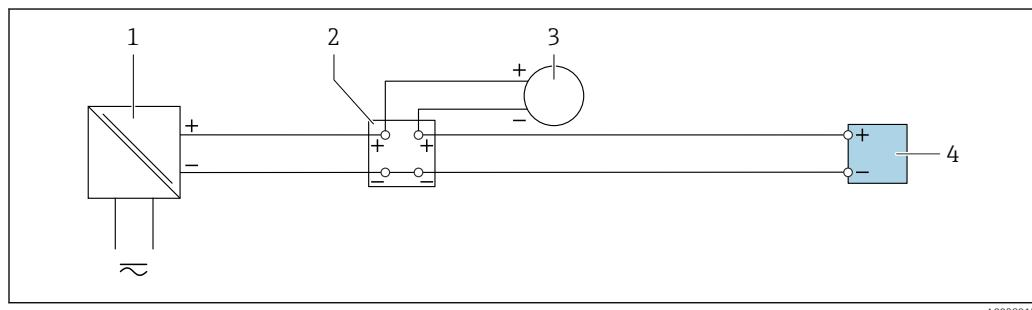
**■ 16 Пример подключения для токового входа 4–20 мА**
