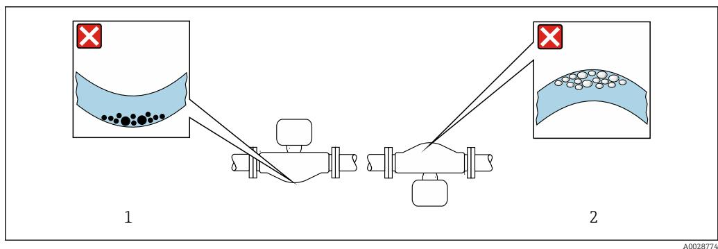
5 Монтажная позиция датчика с изогнутой измерительной трубкой
