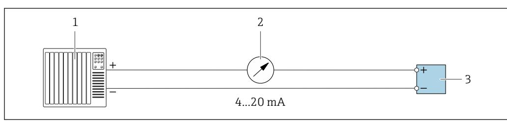
■ 11 Пример подключения для токового выхода 4–20 мА (активного)
