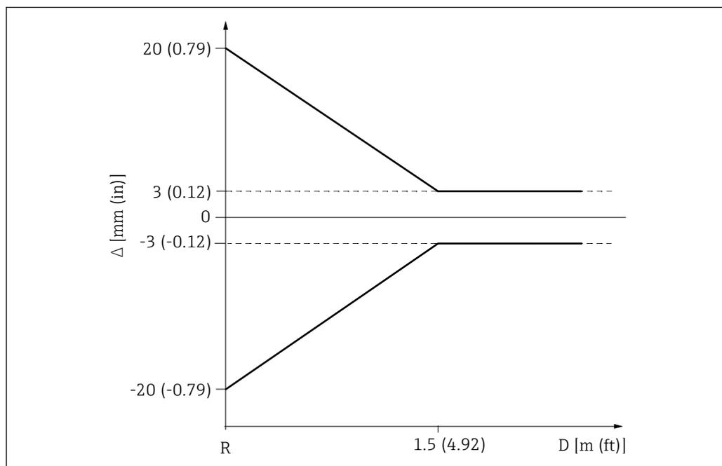
**13** Écart de mesure maximal dans la portée proximale
