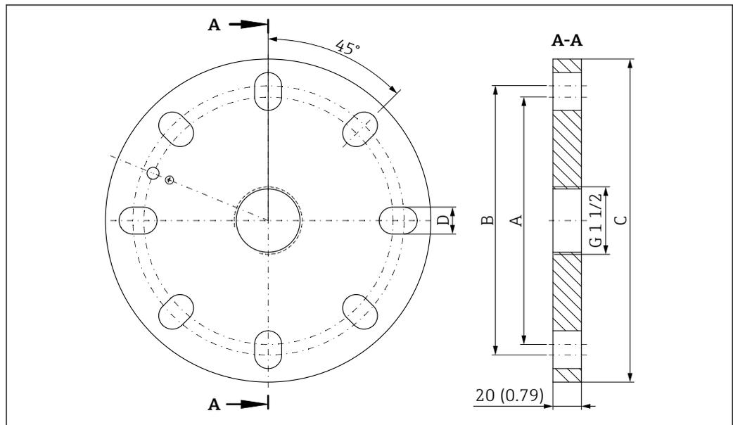
26 Dimensions des brides UNI pour FMR67 sans raccord d'air de purge. Unité de mesure mm (in)
