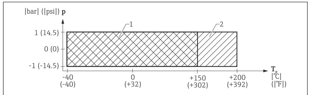
21 FMR67 : Gamme admissible pour la température et la pression de process, antenne, PTFE DN80, bride UNI, ALU, réglable
