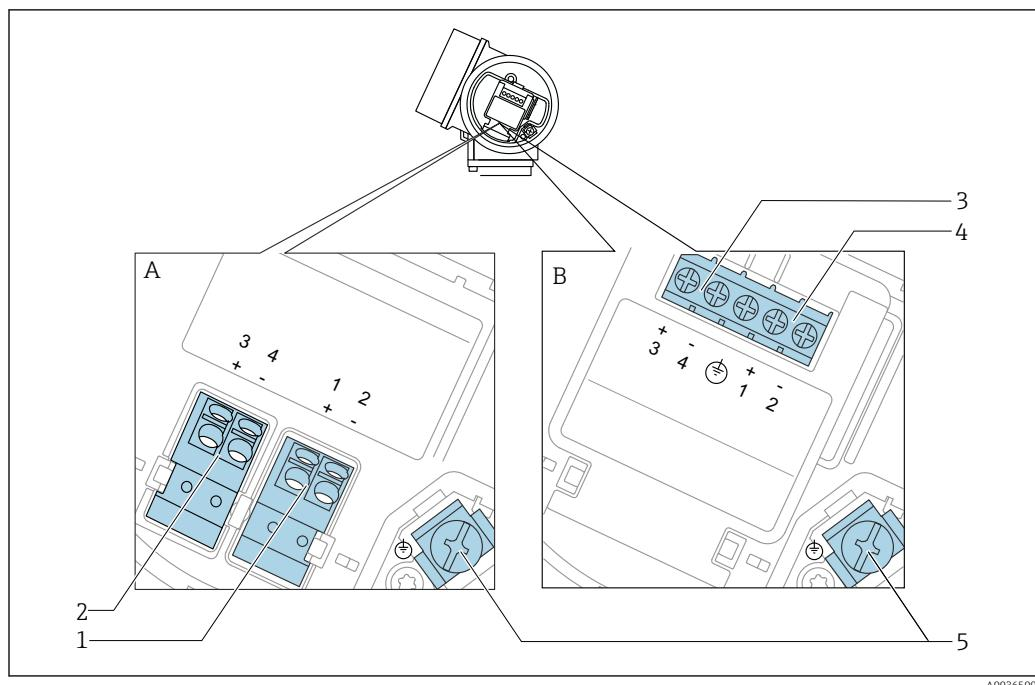
■ 7 Назначение клемм; 2-проводное подключение; 4-20 mA HART, 4-20 mA
