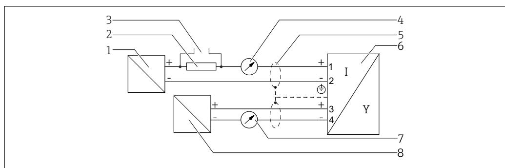
■ 8 Блок-схема 2-проводного подключения: 4-20 mA HART, 4-20 mA
