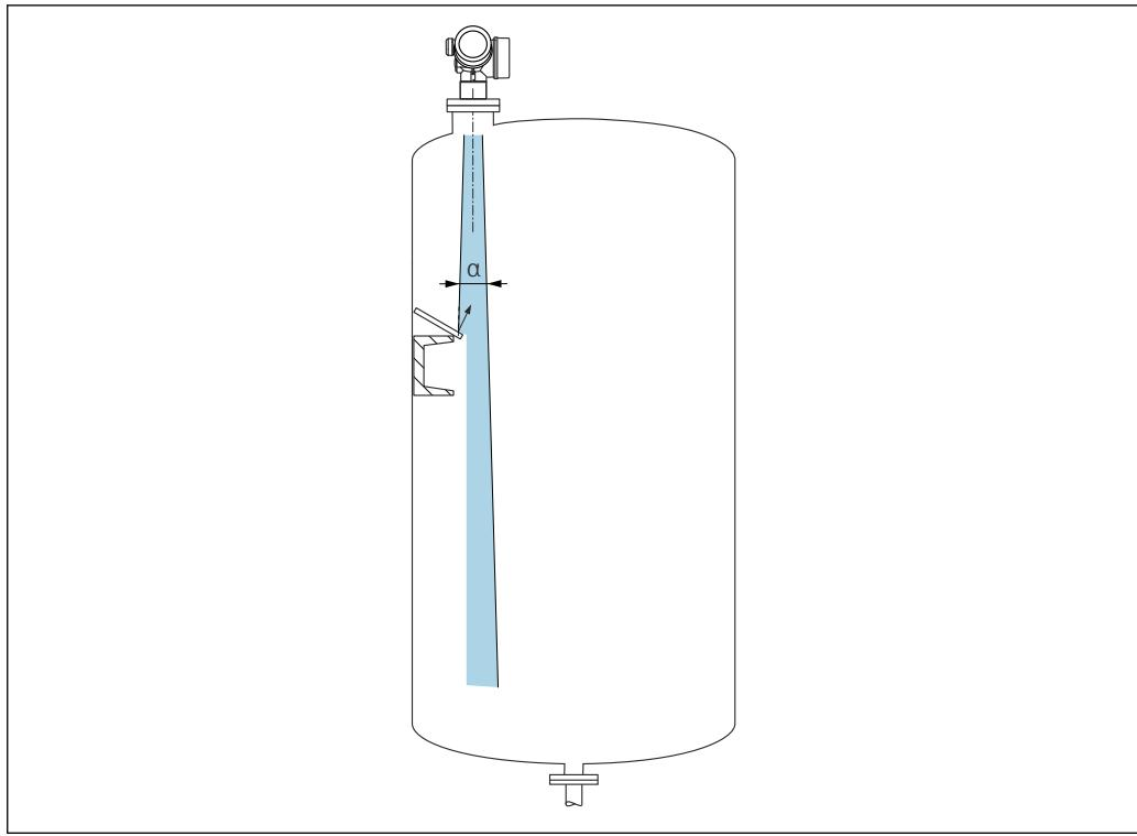
Установленные под углом металлические отражатели для рассеивания сигнального луча способствуют предотвращению эхо-помех.
