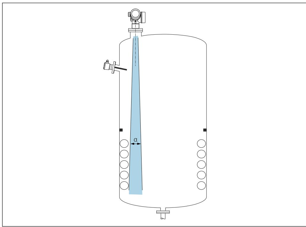
Избегайте установки внутренних устройств (датчиков предельного уровня, датчиков температуры, стержней, вакуумных колец, теплообменников, перегородок и т. п.) в зоне действия сигнального луча. Учитывайте угол расхождения луча.
