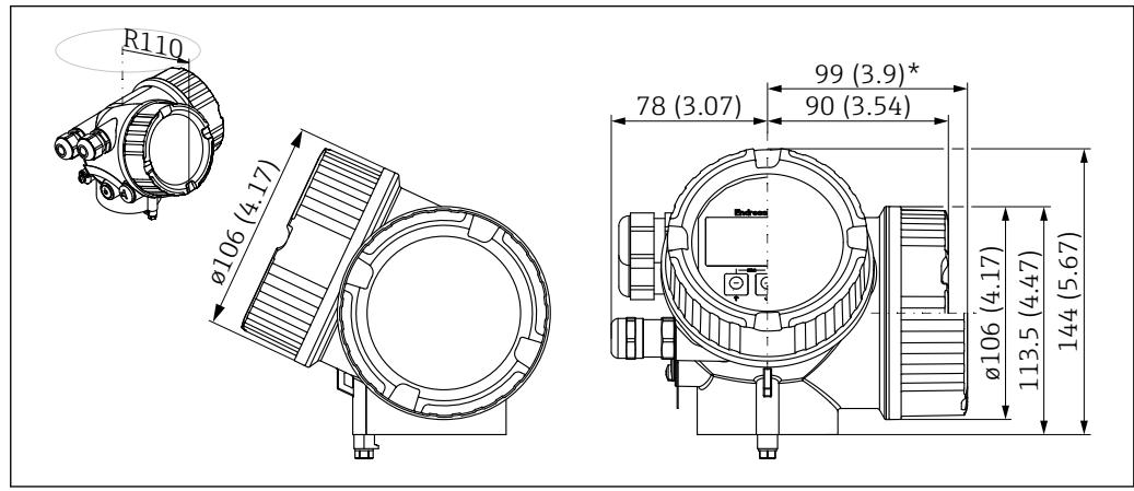
■ 17 Корпус GT19 (пластмасса PBT). Единица измерения мм (дюйм)
