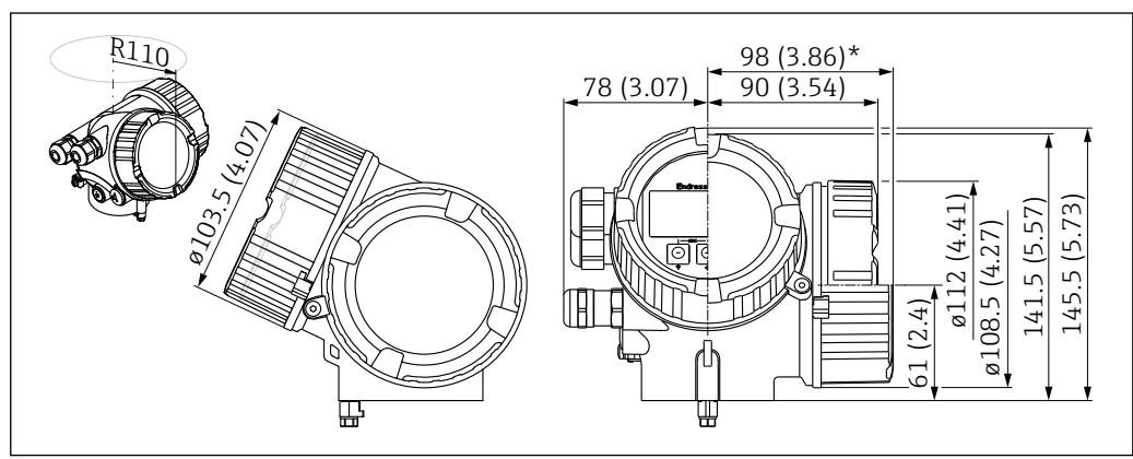
■ 18 Корпус GT20 (алюминий с покрытием). Единица измерения мм (дюйм)
