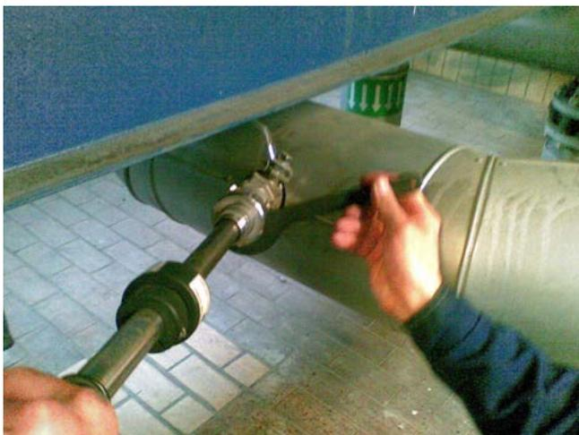
Der Sauerstoffsensor Oxymax COS22D wird mit einer Cleanfit CPA450 Armatur in den Prozess eingebracht.
