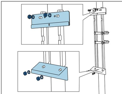
Смонтируйте настенный держатель (входит в комплект поставки анализатора) на фиксаторе стойки.
