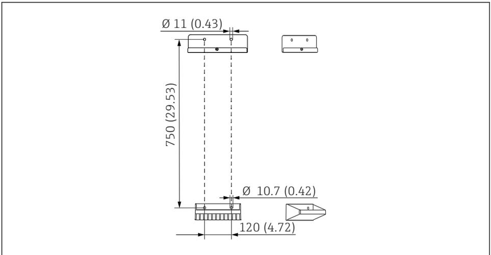
7 Размеры блока держателя. Единица измерения – мм (дюйм)
