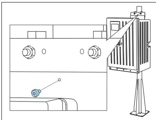
Зафиксируйте верхний стеновой держатель с помощью предлагающегося винта.
