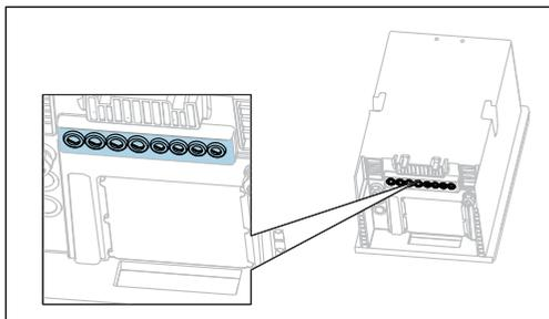
Пропустите кабели через кабельные уплотнения в нижней части прибора.
