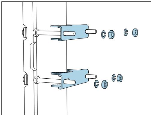
С другой стороны наденьте на стяжные болты вторую часть фиксатора, закрепите пружинными шайбами и гайками.
