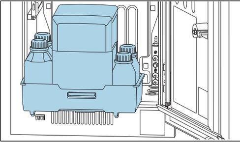
Снимите лоток для бутылей: слегка приподнимите утепленный захват и оттяните его вперед.
