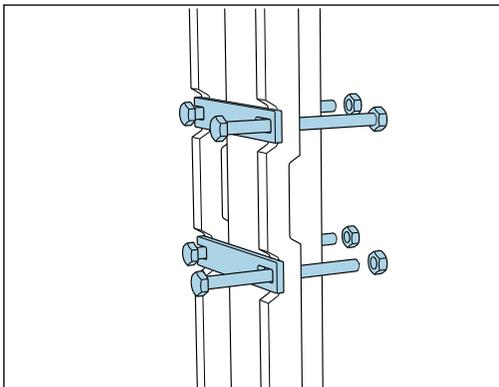
Вставьте стяжные болты в планку и через отверстия в стойке закрепите гайками.
