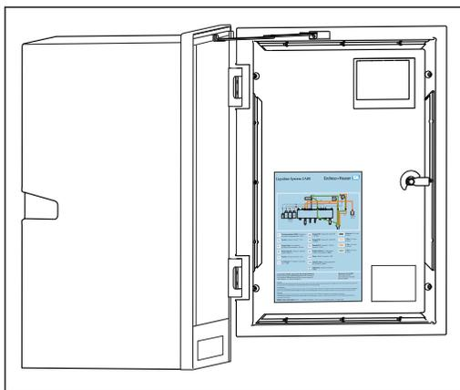
На следующих схемах отражено состояние на момент выпуска этой документации. Схема подсоединения шлангов, действительная для конкретного исполнения прибора, имеется на внутренней стороне дверцы анализатора.
