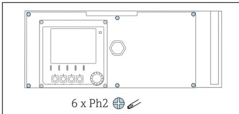
Отверткой с крестообразным наконечником выверните 6 винтов на крышке отсека электроники и разложите крышку вперед.
