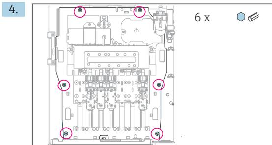
Выверните 6 винтов крепежной панели шестигранным ключом.
