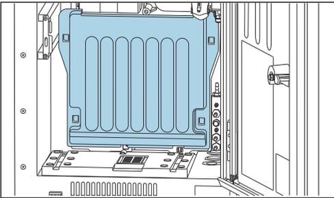
Снимите крышку, закрепленную крючками.
