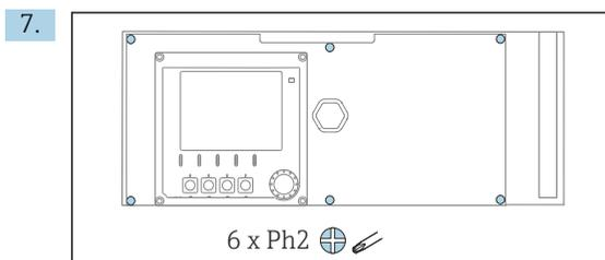
Отверткой с крестообразным наконечником выверните 6 винтов на крышке отсека электроники и разложите крышку вперед.
