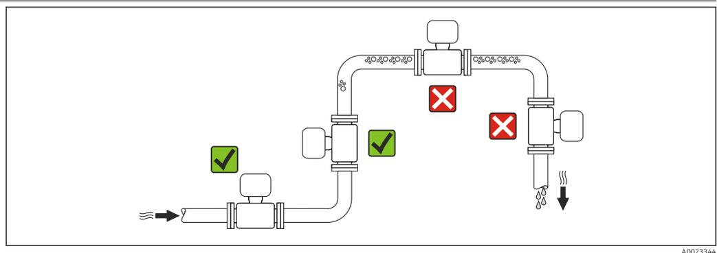
Pour éviter les erreurs de mesure dues à l'accumulation de bulles de gaz dans le tube de mesure, il convient d'éviter les points de montage suivants :
