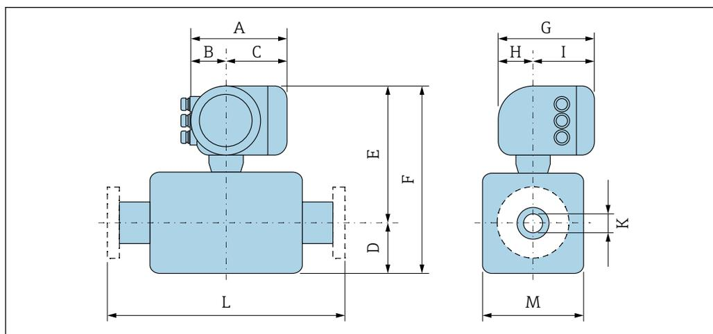
L Longitud instalada con conexión a proceso → 49 específica
