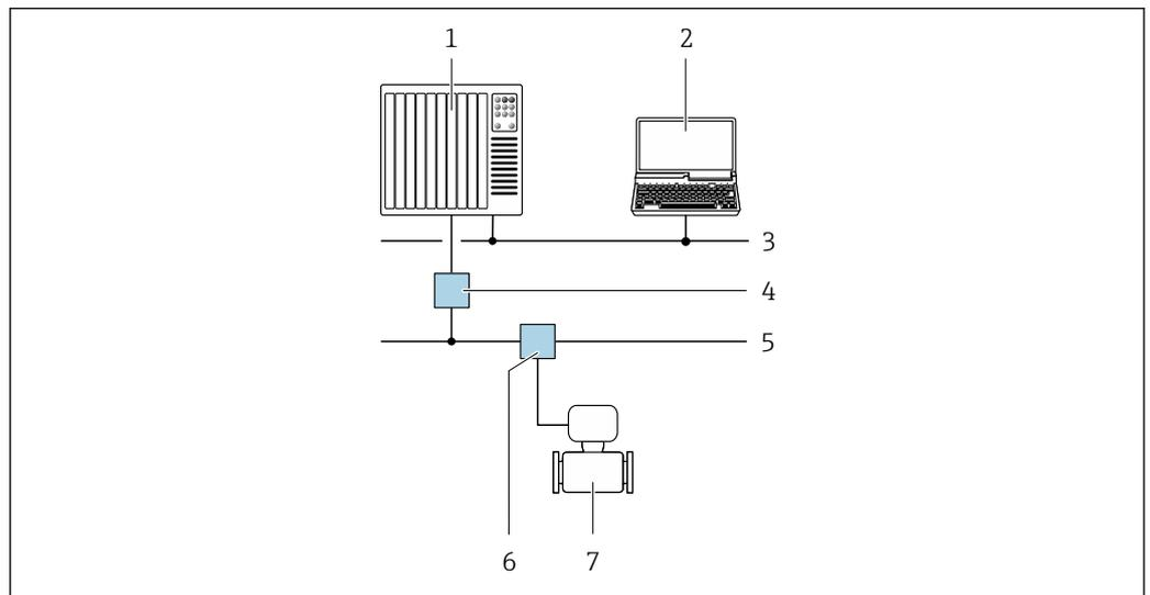
Fig. 22 Opções para operação remota através da rede PROFIBUS PA
