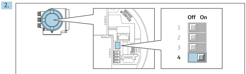
Para comutar o endereçamento do endereçamento de software para o endereçamento de hardware: coloque a minisseletora em **On**.
