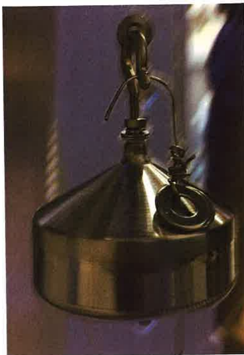
Рисунок 6 – Боек уровнемера с прикрепленным к нему грузом.
