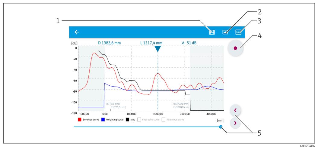
**28** Display de curva envelope (amostra) em SmartBlue para Android
