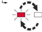
5. Anschließend blinkt die LED abwechselnd grün, gelb, rot und signalisiert damit die Deaktivierung des Messgerätes.
