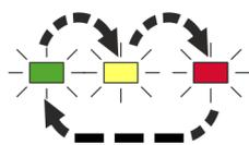
4. Bei fehlerhafter Übertragung blinkt oder leuchtet die LED rot (10 Sekunden).
