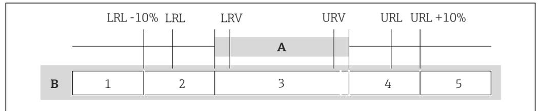
A Bereich des Stromsignals für die Messumformung (NE43) 3,8 ... 20,5 mA
