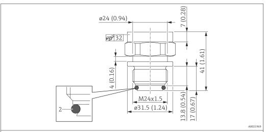
Unité de mesure mm (in). Diamètre de la membrane de process :  $17,2\,\mathrm{mm}$  ( $0,68\,\mathrm{in}$ )
